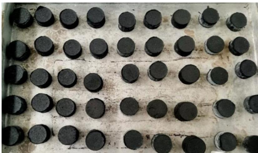
**Figure2. bio-Charcoal briquettes**
